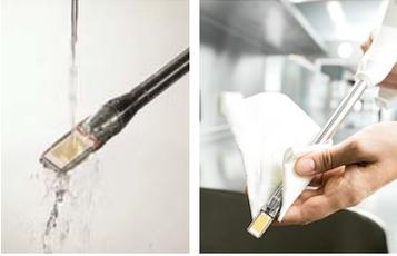
Gerät mit milden Spül-/ Reinigungsmitteln reinigen. Sensor unter fließendem Wasser abspülen und mit einem weichen Papiertuch vorsichtig abtrocknen
