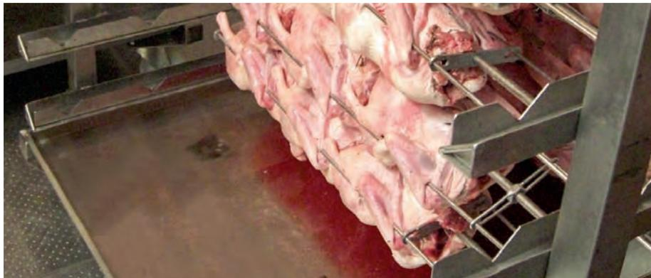
Abbildung 19: Zum Grillen vorbereitetes Geflügel wird auf Drehspießen im Kühlraum zwischengelagert, zur Aufnahme des Fleischsaftes dient die abnehmbare Bodenwanne mit verschleißbarem Ablauf.
