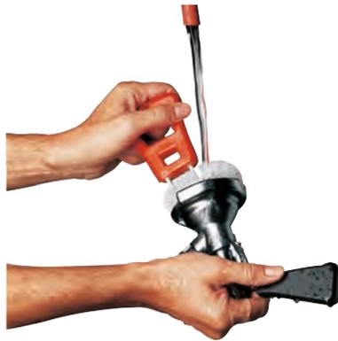
Abbildung 27: Reinigung einer Zapfarmatur
